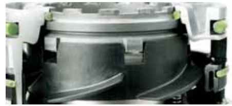
L'elica della pompa di raffreddamento
