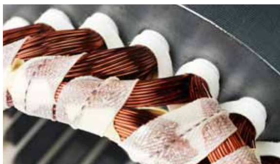
Gli avvolgimenti sono realizzati sempre nel campo delle tolleranze dimensionali.
