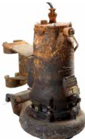
Effetti della corrosione generica su una pompa per acque reflue ancora funzionante dopo 50 anni di utilizzo.
