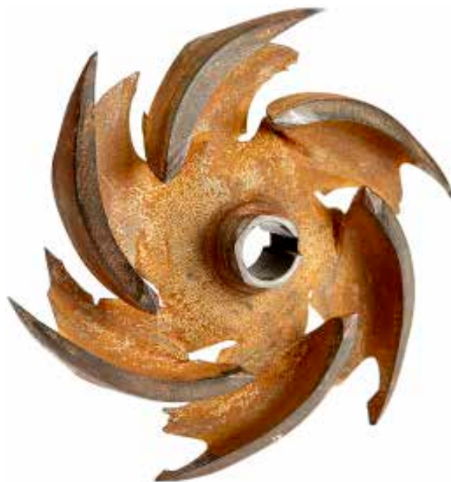
Girante dopo una prova di resistenza all'usura accelerata in laboratorio.
