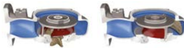
Figura 9: Moderna idraulica autopulente
