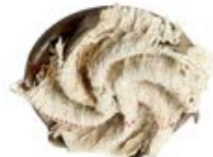
Figura 7: Accumulo in una girante a vortice
