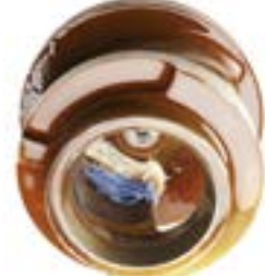
Figura 5: Accumulo in una girante monocanale
