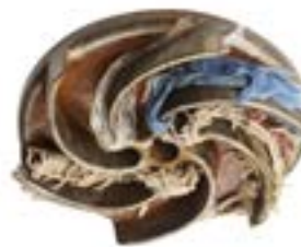
Figura 6: Accumulo in una girante a vortice
