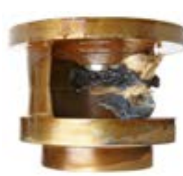
Figura 4: Accumulo in una girante monocanale
