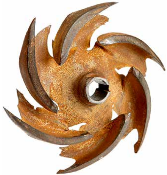
Roue après un essai d'usure accéléré en laboratoire.
