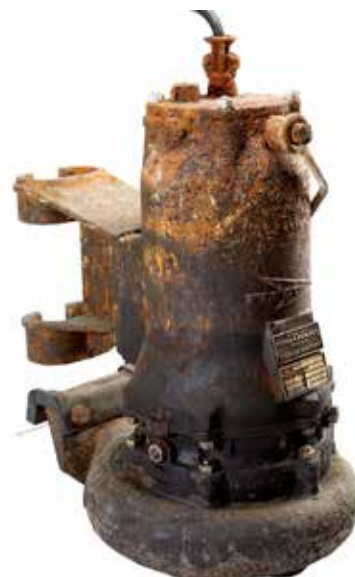
Les effets de la corrosion sur une pompe à eaux usées encore en fonction après 50 années d'utilisation.
