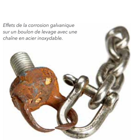
Figure 2: Le potentiel électrique des métaux peut être mesuré dans différentes solutions aqueuses et listé dans des séries galvaniques
