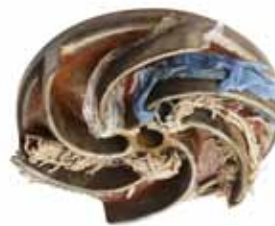
Figure 6: Accumulation dans un impulseur vortex
