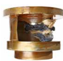
Figure 4: Accumulation dans une roue à pale simple
