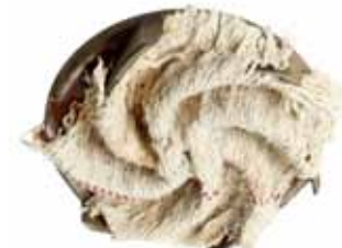
Figure 7: Accumulation dans un impulseur vortex
